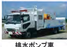
排水ポンプ車
