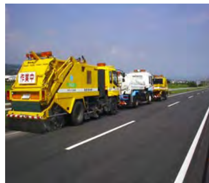
路面清掃車・散水車
