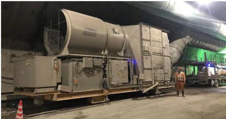
上の写真は、トンネル内にある集じん機です。巨大な空気清浄機のような機械で、砂ほこり等を除去して空気をきれいにすることができます。トンネル内は、空気の逃げ場が少なく、掘削には重機を多数使用するため、集じん機によって中の空気をきれいにして、安全に作業できる環境を整えています。
