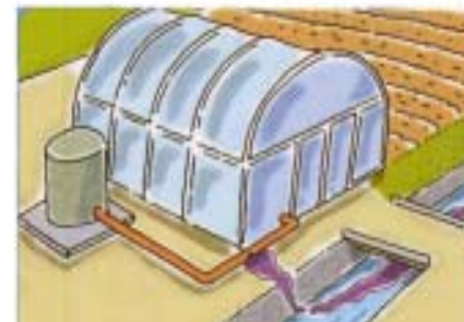
配管の老朽化・亀裂による油漏れ
