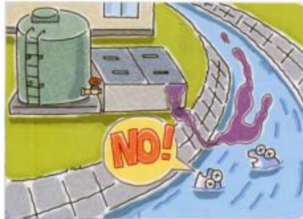
油水分離槽のオーバーフローによる油流出
