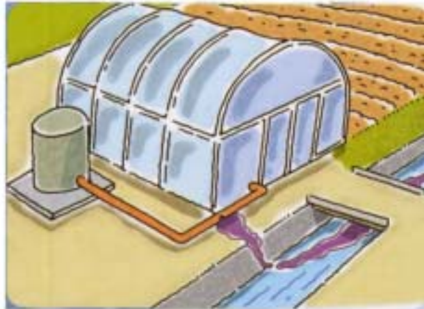
配管の老朽化・亀裂による油漏れ
