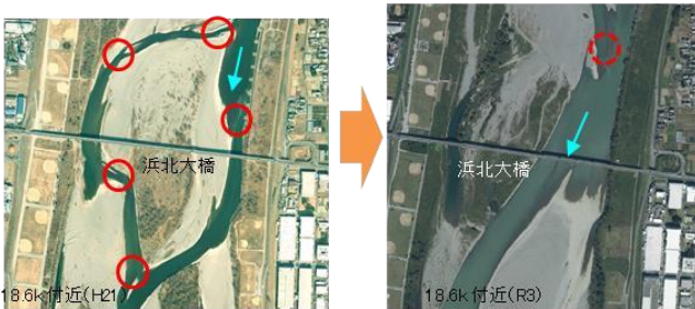
※複列砂州が形成されていたときは、複数のみお筋それぞれに瀬が存在していたが、みお筋が固定化され、瀬が減少している
