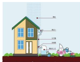
雨水タンクの使用方法
