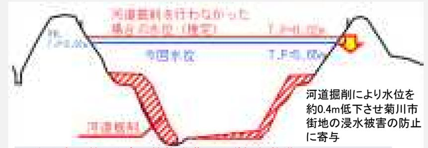
3か年緊急対策と災害対策推進費の河道掘削整備延長：L=8,400m
