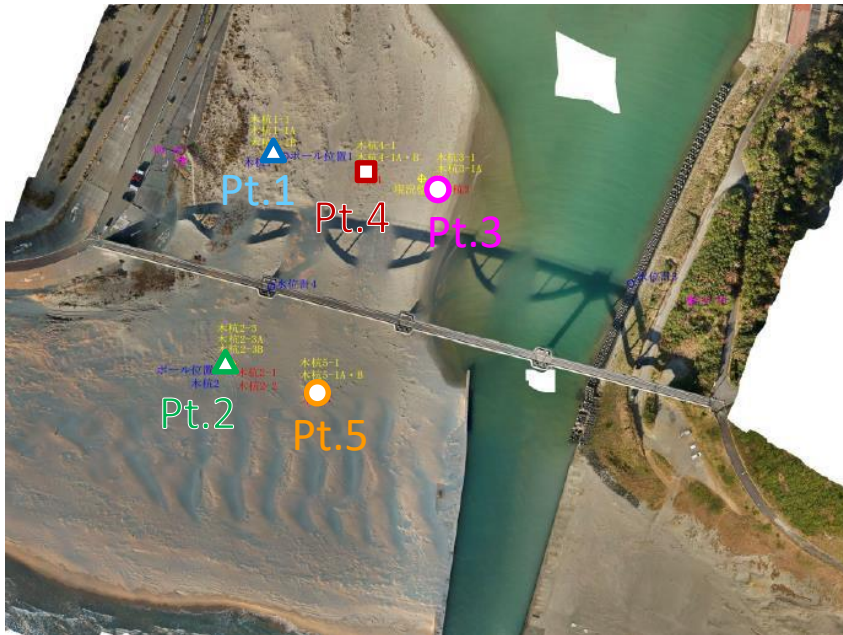
着色砂の設置箇所
