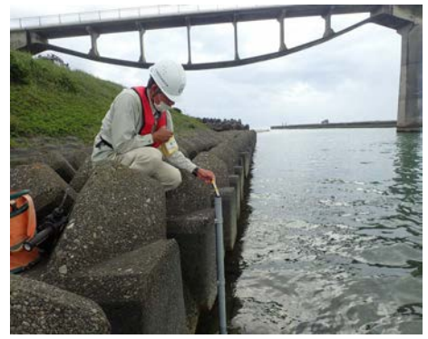
左岸0.2k水位計
