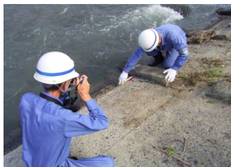
河川巡視状況(護岸・床止め 損傷状況確認)
