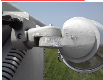
黒沢川排水樋門 監視カメラ 塗装剥離状況
