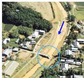
昭和57年9月洪水 菊川 水神橋の落橋 （菊川市吉沢、菊川15k8付近）
