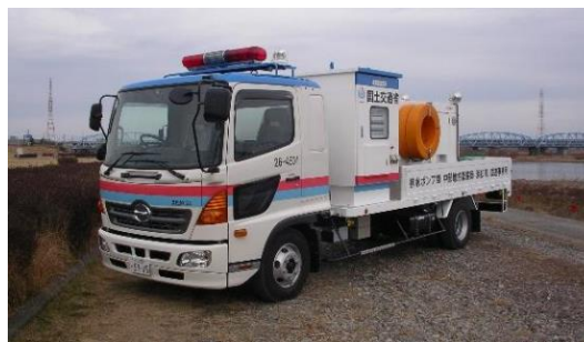
排水ポンプ車
