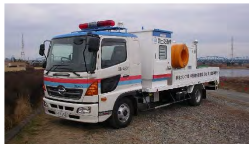
排水ポンプ車
