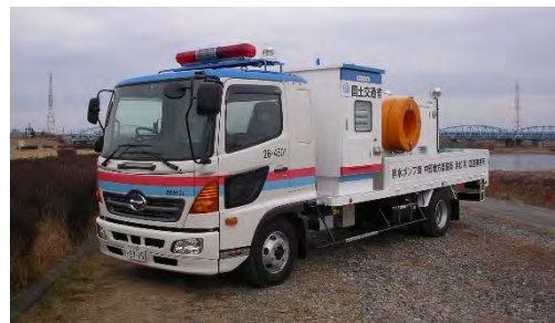
排水ポンプ車
