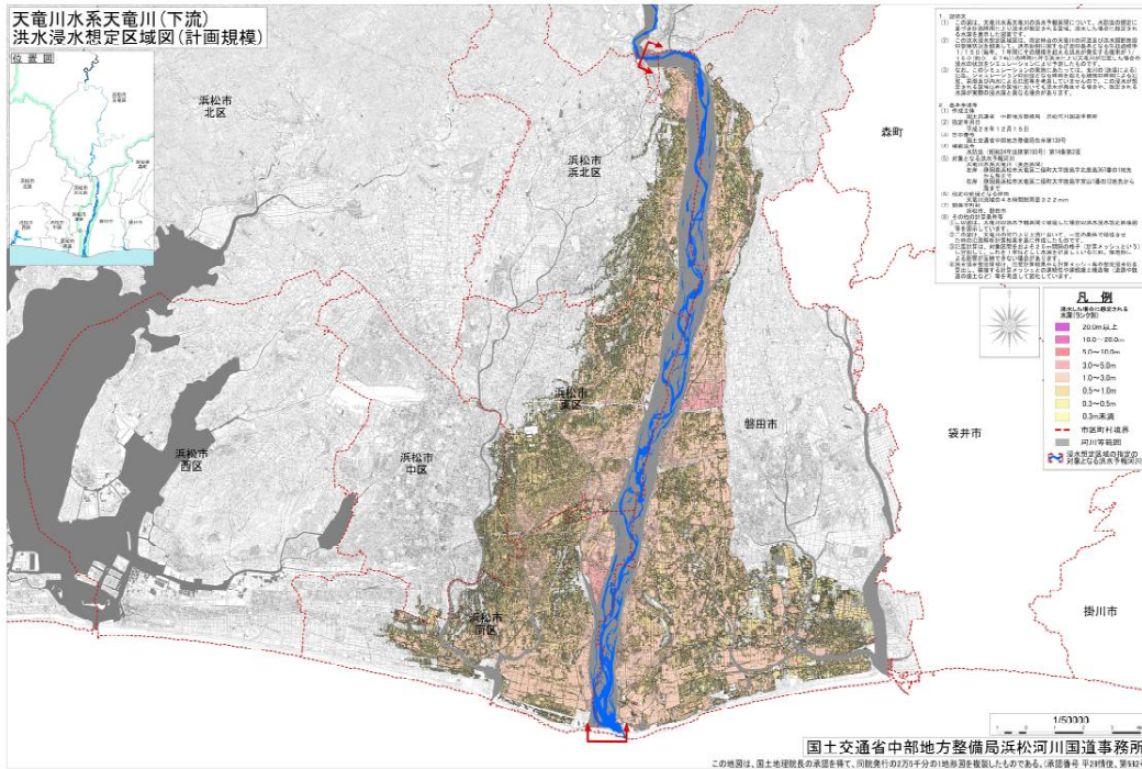
計画規模(L1:W=1/150雨量確率規模)
