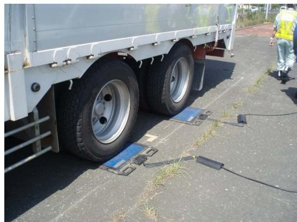
マットスケールによる車両重量計測
