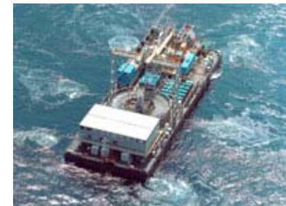
ケーブル敷設台船「天山」, 一本松物流株式会社 川崎重工HP( https://www.khi.co.jp/machinery/product/ship/kics.html )より
