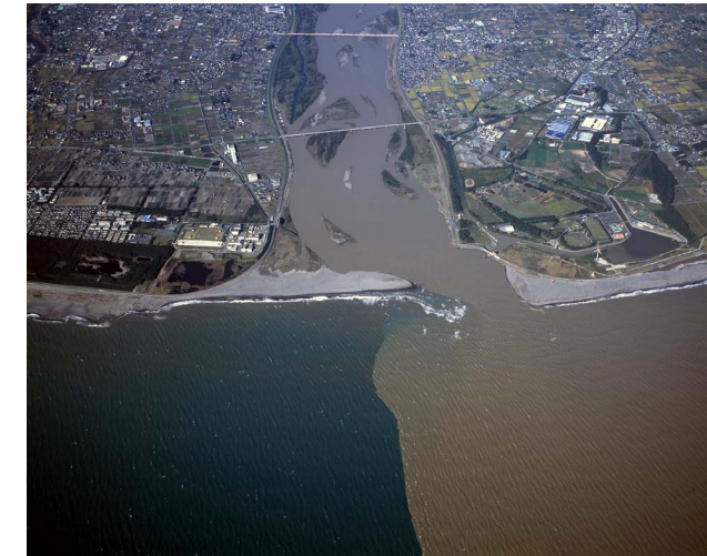
図 3-23 洪水時の濁水拡散状況 (H16. 10. 23, 鹿島 Q_p=4,400\text{m}^3/\text{s} )
