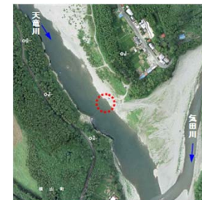
上流候補地点40.0k左岸 (土砂が堆積しやすい支川合流部)
