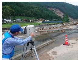
斜面崩壊現場の 24時間監視
