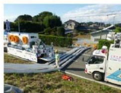
排水ポンプ車による排水状況
