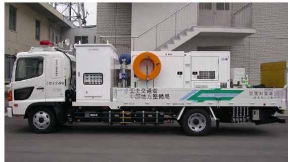
排水ポンプ車(4台)
