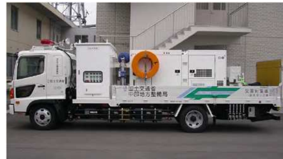
排水ポンプ車(4台)
