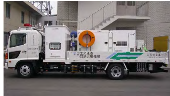
排水ポンプ車(3台)
