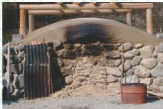
窯の中の温度が十分に高くなったら 入口と煙突にふたをする
