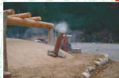
煙突から出る煙の色で焼け具合を確認 煙は始めは白く、やがて青色から透明に変化
