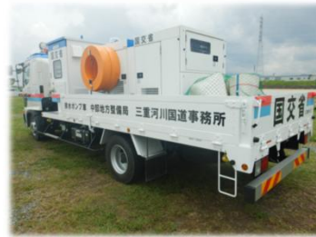
排水ポンプ車 (30m 3 /min 揚程10m)
