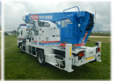
照明車 (照明灯高さ20m)
