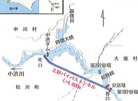
【土砂バイパストンネル】 形状：標準馬蹄形 延長：約4,000m 縦断勾配：1/50
