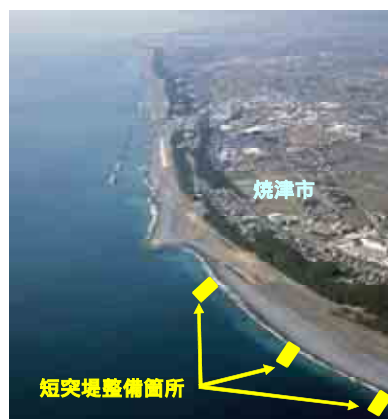
駿河海岸 焼津工区 短突堤の整備により著しい海岸侵食を防ぐ
