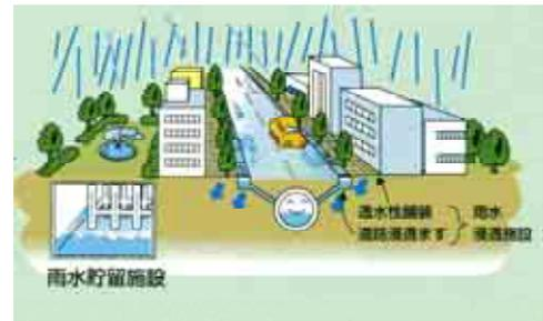
下水道による浸水対策の事例
