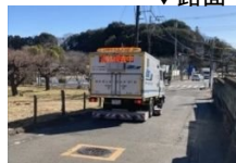
(空洞探査車による調査)
