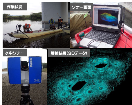
レーザースキャナによる洗掘状況の把握
