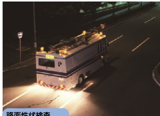
路面性状検査
