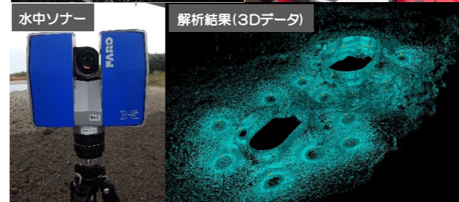
レーザースキャナによる洗掘状況の把握
