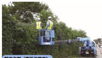
剪定作業（高所作業車）
