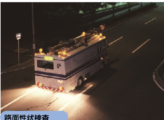
路面性状検査
