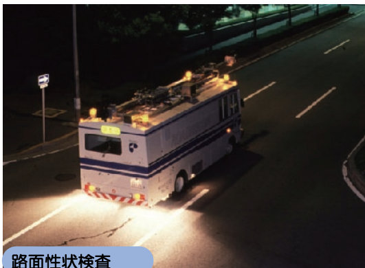
路面性状検査
