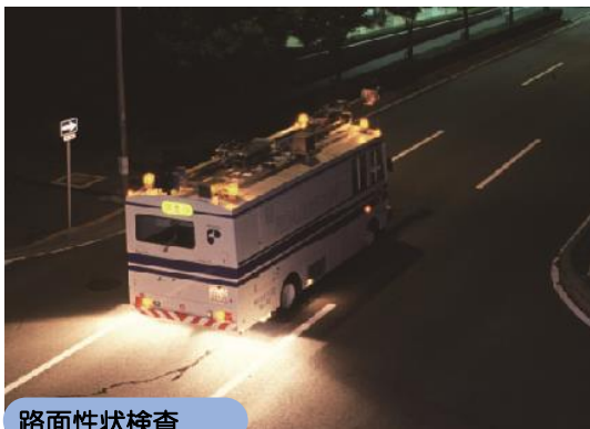
路面性状検査
