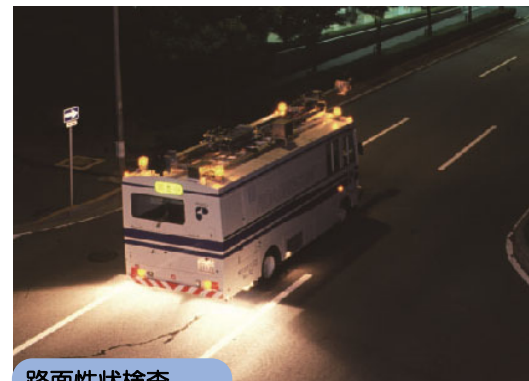
路面性状検査
