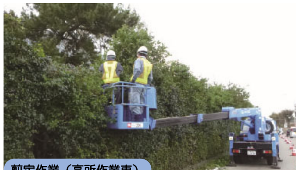
剪定作業（高所作業車）
