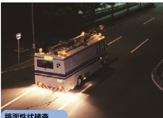
路面性状検査
