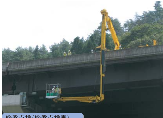
橋梁点検(橋梁点検車)
