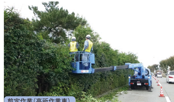
剪定作業(高所作業車)
