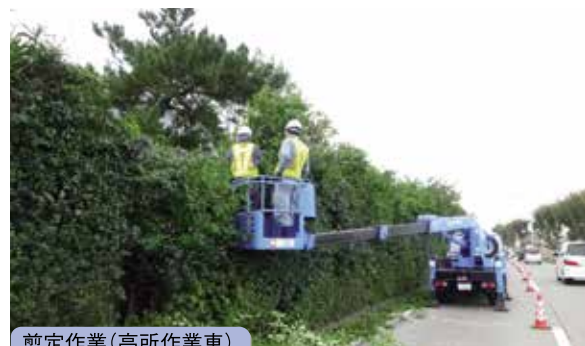
剪定作業(高所作業車)
