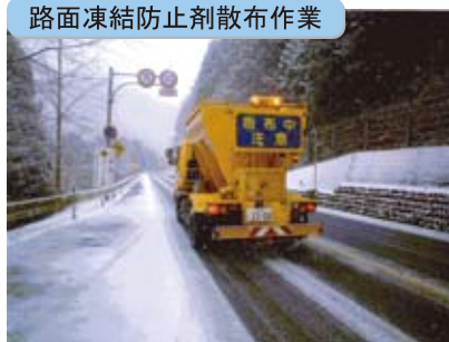
路面凍結防止剤散布作業
