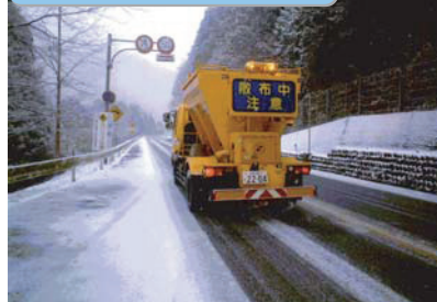
路面凍結防止剤散布作業
