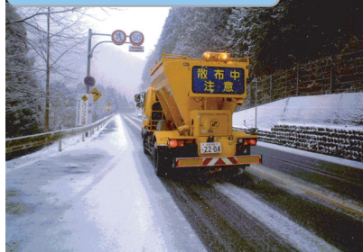
路面凍結防止剤散布作業
