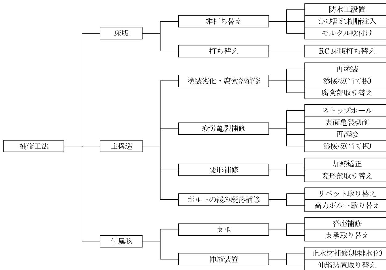
図-8.5.33 鋼橋の主な補修工法
