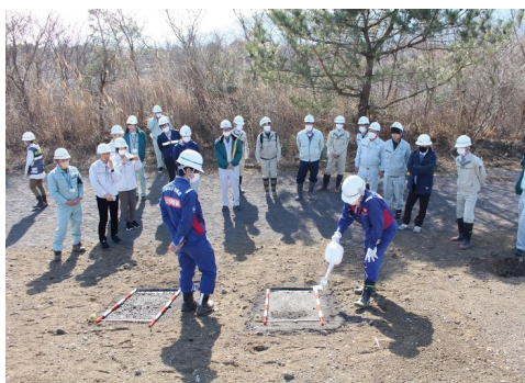
浸透能試験の実施状況 (令和6年2月)
