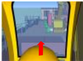
危険ポイントを3D化し、オペレータ視点で確認
