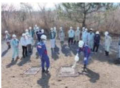
浸透能試験の実施状況 (令和6年2月)
