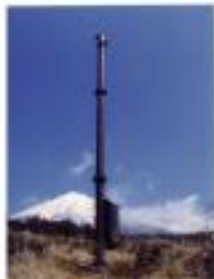
(火山監視用)CCTVカメラ
