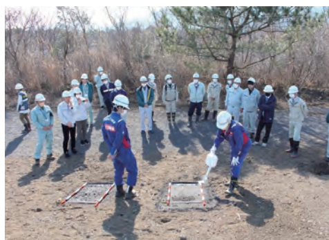
浸透能試験の実施状況 （令和6年2月）
