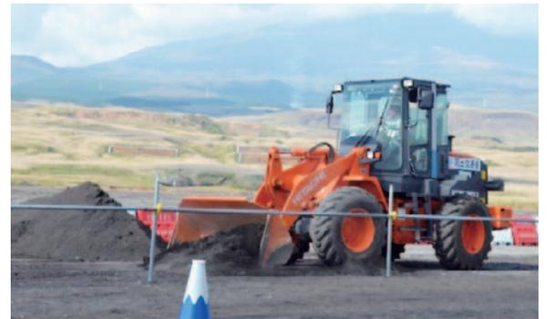
道路啓開での降灰に見立てた土砂撤去
